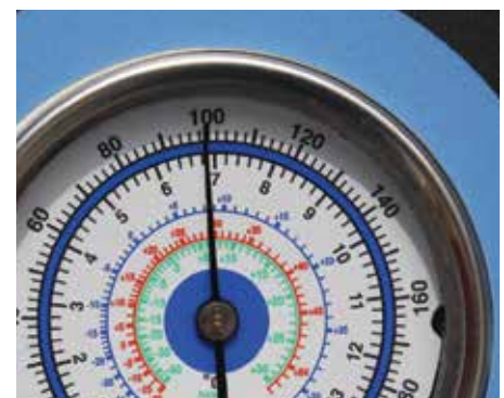
Serienmäßiges Kältemanometer an der Seite des Gehäuses zur einfachen Fehlerdiagnose
